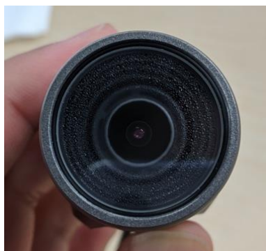
結露が発生したカメラ
