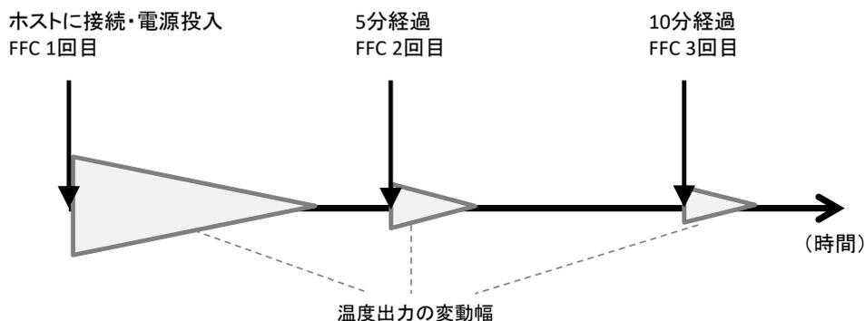
電源投入直後は温度出力の変動幅が最も大きな状態です。徐々に安定して 2 回目の FFC が実行されると再び大きく変動します。このときの変動幅は電源投入直後よりも小さくなります。その後、5 分毎の FFC 実行直後に変動し、センサ自体の温度が平衡状態に入ったとき最も安定します。通常、安定するまでに、1 回目の FFC から 5~10 分程度要します。安定した状態に至っても、FFC が実行された直後には多少変動します。
